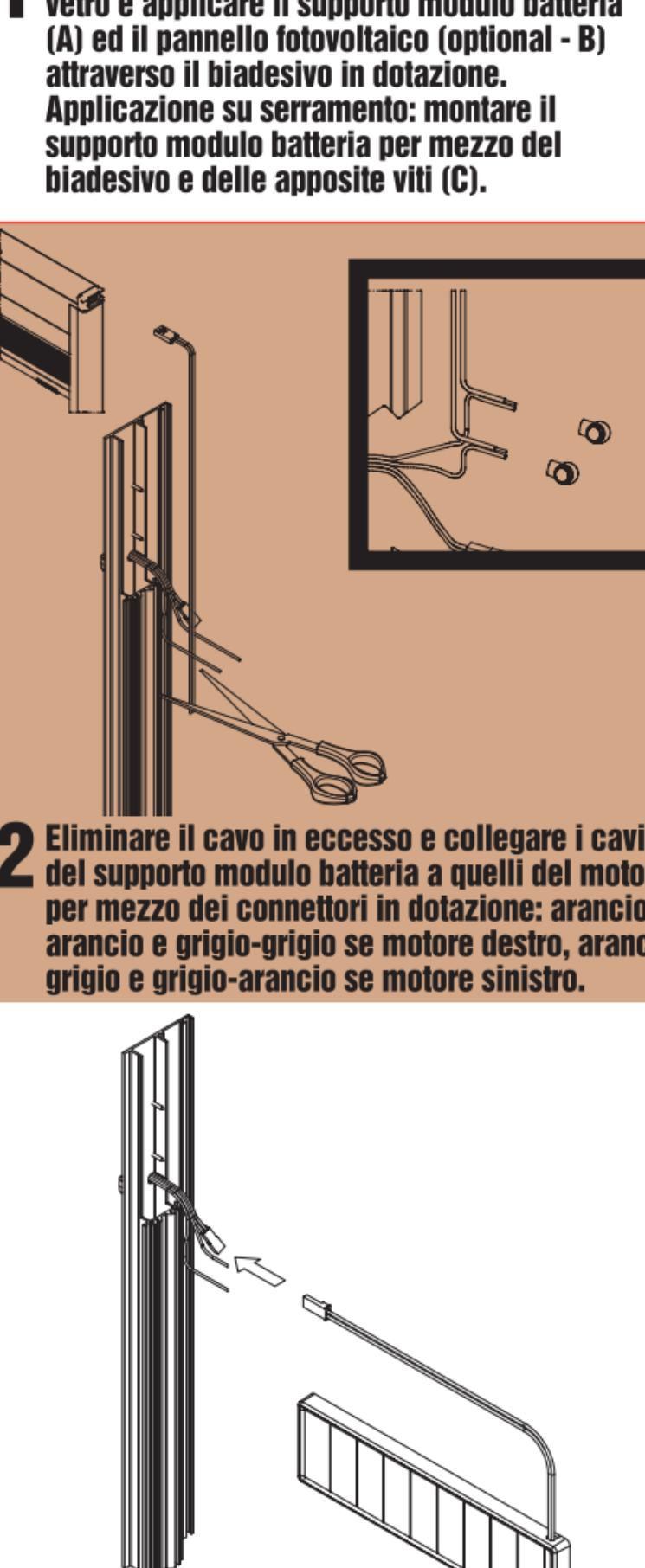
**1** Applicazione su vetro: pulire perfettamente il vetro e applicare il supporto modulo batteria (A) ed il pannello fotovoltaico (optional - B) attraverso il biadesivo in dotazione.
