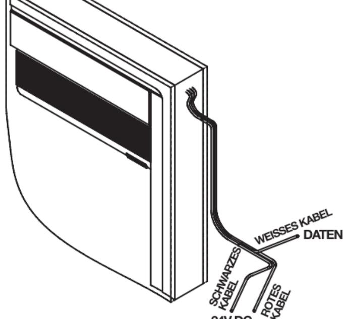
PS.: FÜHREN SIE ALLE DREI KABEL ZUR STEUERUNGSEINHEIT
