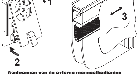
Aanbrengen van de externe magneetbediening
